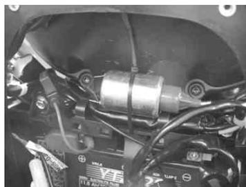
9. 先ほど仮付けした オープナーモーターCOMP.のケーブルを完全に引き出し、ケーブルのたるみをなくします。（この作業を省くと正常に作動しない可能性があります。確実にケーブルを全て引き出して下さい。）
