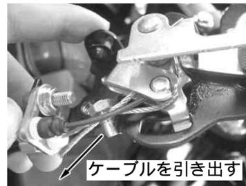
10. ワイヤロックスクリューのネジを外れないように締め付けます。
