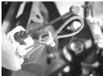
6. ワイヤーの輪と純正のラゲッジボックスリッドロックケーブルを、ラゲッジボックスリッドキャッチに取り付けます。この時、純正のラゲッジボックスリッドロックケーブルのタイコ部に、ワイヤーの輪を引っ掛けるように取り付けて下さい。
