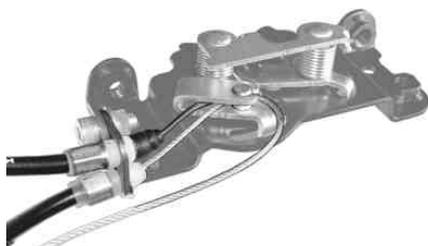
7. 引っ掛けたワイヤーで輪を作るとして、ワイヤーロックスクリューを仮付けします。
