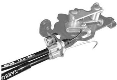
5. オープナーモーターCOMPを図の場所にタイラップ250mmで取り付けます。(ケーブルはラゲッジボックスと、エアクリーナーの間を通し、オープナーモーターCOMPが動かない様にしっかり固定して下さい。)
