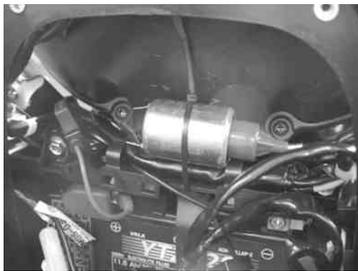
6. オープナーモーターCOMPから出ているワイヤーを、純正ラゲッジボックスリッドロックケーブルのタイコ部に引っ掛けるように取り回します。
