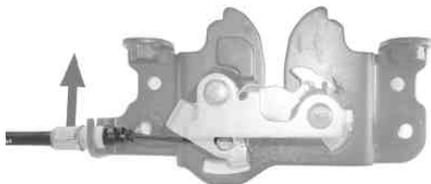
2. 図を参照し、ケーブルガイドに純正のラゲッジボックスリッドロックケーブルと、オープナーモーターCOMPのケーブルアウターを取り付けます。
