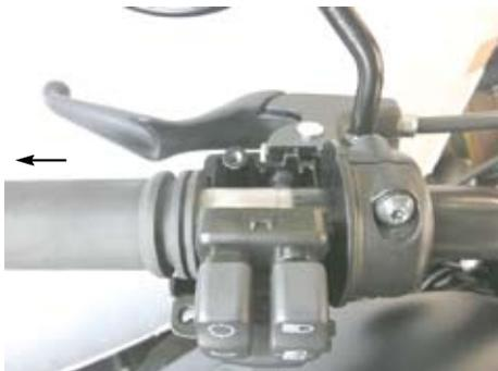
○右スイッチボックスのスクリュー 2 本を取り外し、グリップを取り外します。
