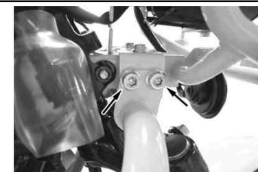
アンダーガードのフランジボタヘッドソケットスクリー 4 本を規定トルクまで締め付けます。
