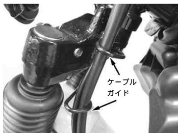
ハンドルを左右に切りケーブル類が他の部分に干渉がないかを確認します。フロントカバーを加工します。フロントカバーとL/Rパイプとの干渉部を加工します。下記に簡易的に寸法を示しています。干渉部を少しずつ加工します。
