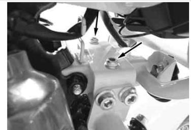
メインステップのソケットキャップスクリーン4本を規定トルクまで締め付けます。
