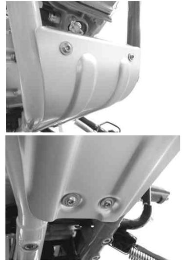
ホルダーのフランジソケットキャップスクリーン2本を規定トルクまで締め付けます。
