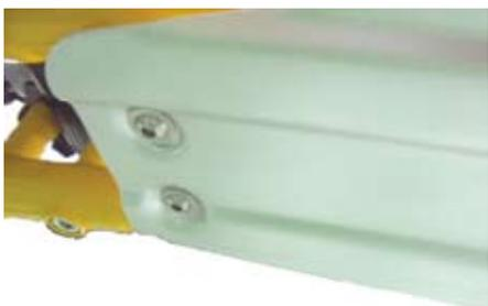
○①パイプ R COMP. / ②パイプ L COMP. とヘッドライトステーとのクリアランス及び位置を調整する。
