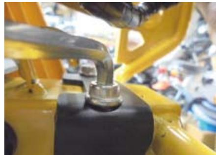
○メインステップ部の⑧ソケットキャップスクリュー 8x75 4本を規定トルクまで締め付ける。
