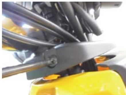
○フロントカバーを取り付けているスクリューを外し、フロントカバーを取り外す。
