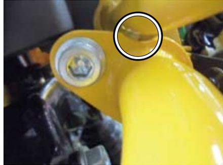
○①パイプ R COMP. / ②パイプ L COMP. の位置調整が終われば、ホルダーの⑥フランジソケットキャップスクリュー 6x45 2本を規定トルクまで締め付け、ヘッドライトのハーネスを元の位置に配置する。
