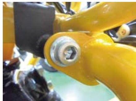
○⑤アンダーガード部の⑨フランジボタンヘッドソケットスクリュー 6x8 4本を規定トルクまで締め付ける。
