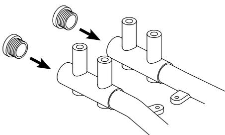
○キット内パーツのタップ部は塗装膜厚が載っており、取り付け前に一旦キット同梱のボルトを各パーツタップ部に挿入させる事で、取り付け時の作業性が向上します。
