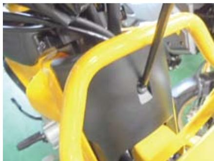
○ヘッドライトステーとヘッドライトケースを止めているボルト 2 本を取り外し、ヘッドライトを取り外す。
