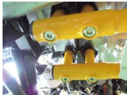
○①パイプ R COMP. / ②パイプ L COMP. フランジ側の⑦フランジソケットキャップスクリュー 8x16 2本を規定トルクまで締め付ける。
