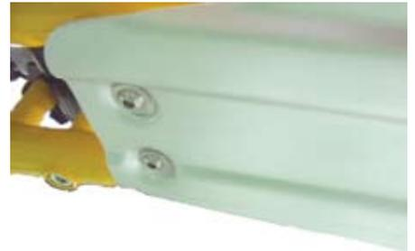
○フロントカバーを取り付け、ハンドルポストフロントカバーを取り付ける。
