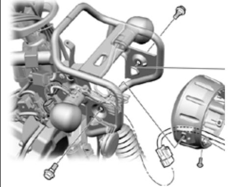
○ヘッドライトステー下部にキットの③ホルダー COMP. の切り欠き部を車両後方に向け、ヘッドライトステーをキットの④クランプで挟み込む様に取り付け、⑥フランジソケットキャップスクリュー 6x45 を用いて取り付け仮締めをする。
