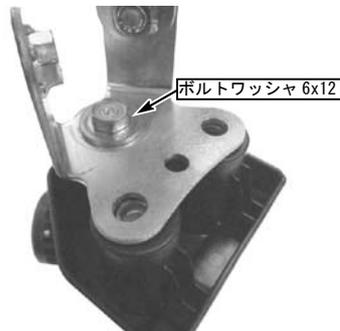
○取り外しと逆手順でフレームに、左右のフロントステー、フロントステーカバー、L/RパイプCOMP. をノーマルのアンダーカバーパイプ同様に取り付け各スクリューを仮締めする。
