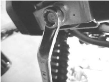
○L/R パイプ COMP. の位置を調整し、L/R パイプ COMP. のステアにノーマルのアンダーカバーの爪を引っ掛けパンスクリュー 6x10 にて取り付け。
