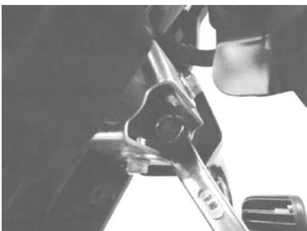
○ステップパー部のフランジボルト 8x16 及びフロントステアカバー部のソケットボルト 8x16 を締め付ける。
