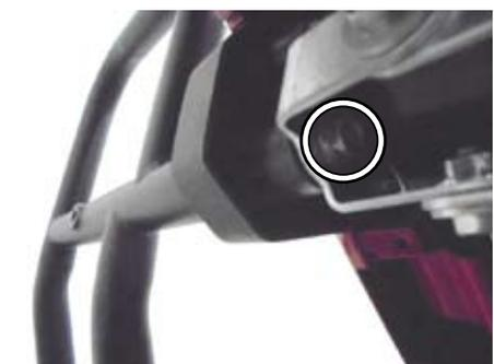
○ステップバーに L/R パイプ COMP. を純正の M8 ボルトで取り付け仮締めをする。
