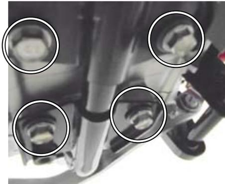
○フロントステーカバー及びフロントステーの切り欠き部と、パイプ COMP. の切り欠き部を合わせ、パイプ COMP. をフロントステーに純正の M6 ボルトで取り付け仮締めをする。
