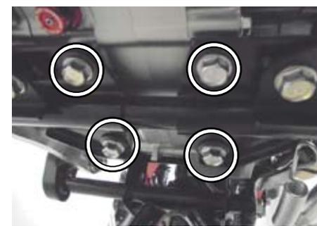
○L/R パイプ COMP. の位置を調整し、ステーにノーマルのアンダーカバーの爪を引っ掛け後方のパンスクリューを取り付けてから前方のパンスクリューを取り付け、アンダーカバーの位置を調整した後、規定トルクまで締め付ける。
