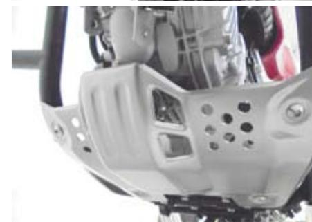
○フロントステーと L/R パイプ COMP. を止めている左右の純正 M6 ボルトを締め付ける。
