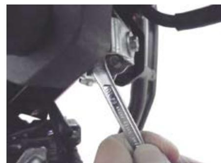
○ステップバー部の左右 M8 ボルトを締め付ける。
