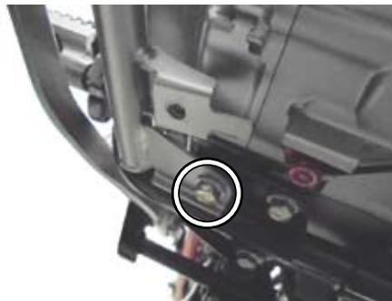
○フロントステーカバー、フロントステーは取り外さず、左右のフロントステーとアンダーカバーパイプに取り付けている M6 ボルトを取り外す。
