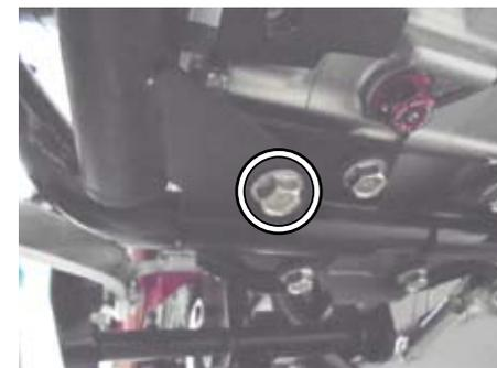
○ステップバーの4本のボルトを規定トルクまで締め付ける。
