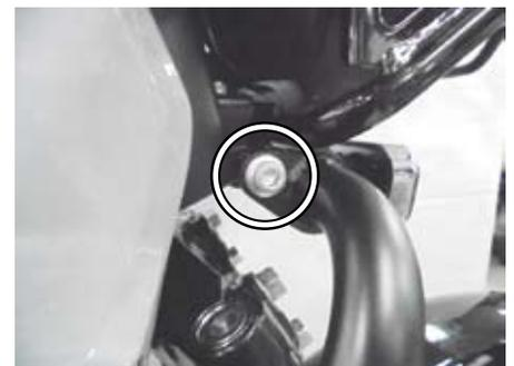
○①パイプ R COMP. 後側のステーと⑥アタッチメントのボス部にメインステップを取り付けてあった純正ボルトを用いて仮締めします。
