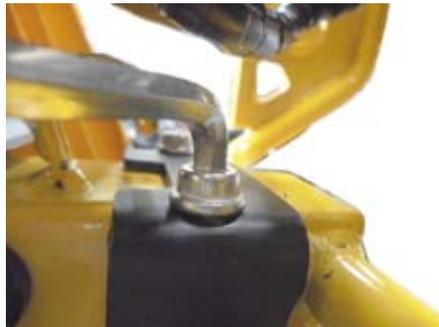
○⑨アンダーガード部の⑩フランジボタンスクリュー 6x8 を締め付けます。
