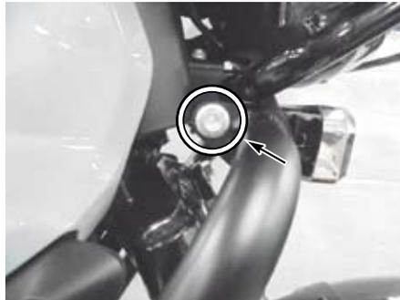
○①パイプ R COMP. / ②パイプ L COMP. クランクケース側ステー部の純正フランジボルトを締め付けます。
