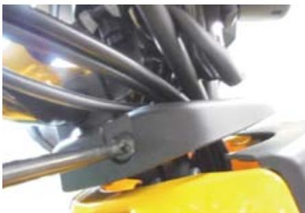
○フロントカバーを取り付けているスクリーンを外し、フロントカバーを取り外します。
