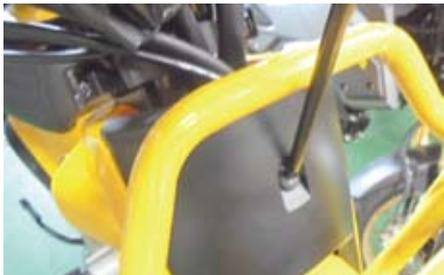
○ヘッドライトステーとヘッドライトケースを止めているボルト2本を取り外し、ヘッドライトを取り外します。
