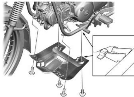
○左右のフロントステーカバー部のソケットボルト及びステップパー部のフランジボルトを規定トルクまで締め付けます。
