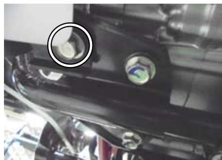
○③タワーバー部の④ボタンヘッドスクリューを規定トルクまで締め付けます。
