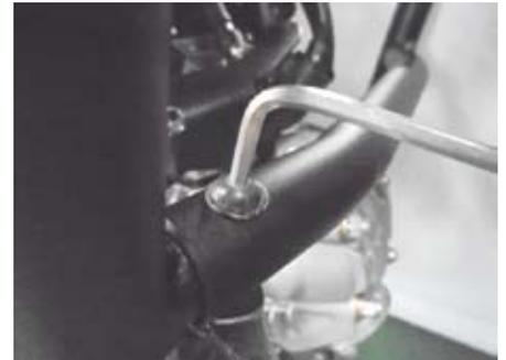
○アンダーカバーのパンスクリュー 6x10 を規定トルクまで締め付けます。
