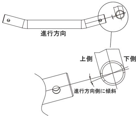
○取り付けした①パイプ R COMP. 突起パイプ部に③タワーバーを差し込み、④ボタンヘッドスクリュー、⑥プレーンワッシャ、⑤フランジUナットで仮締めします。
