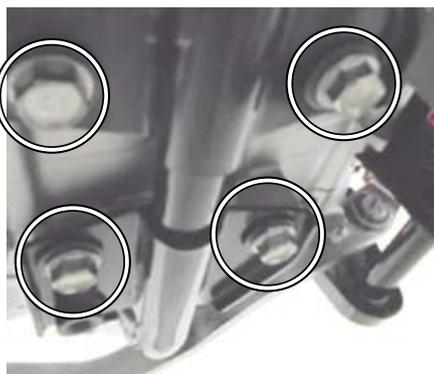
○①パイプ R COMP. フランジ付け根パイプの穴にフロントステアカバーの突起部を合わせ、フロントステアカバー前方に⑧カラー、⑦フランジボルト 8x55 をセットし、後方は純正ソケットボルトを利用し車両に仮付けし、①パイプ R COMP. ステア部をステップバーに純正フランジボルトで仮締めします。この時、①パイプ R COMP. の位置が微調整可能な位の仮締めにしておきます。
