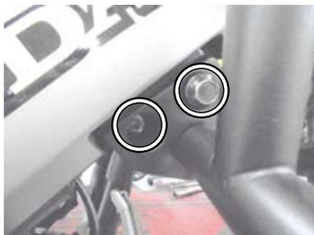
○パイプ R/L COMP. 後方のステー部、ステップバーに取り付けた純正フランジボルトを規定トルクまで締め付けます。
