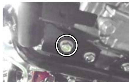
○③タワーバーを①パイプ R COMP. 突起部に差し込みセットし、④ボタンヘッドスクリュー 5x30、⑥プレーンワッシャ 5mm、⑤フランジUナットを用いて仮締めします。
