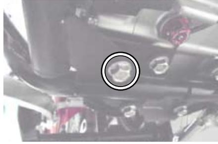
○③タワーバー両端の④ボタンヘッドスクリューを規定トルクまで締め付けます。
