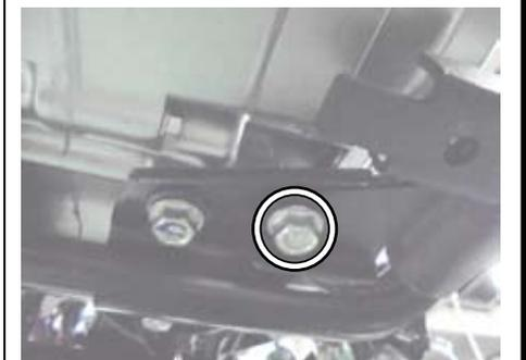
○ステップバーの4本の純正フランジボルトを規定トルクまで締め付けます。
