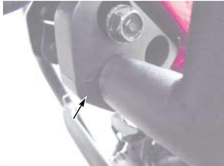
○取り外したメインパイプローアカバーを取り付けます。
