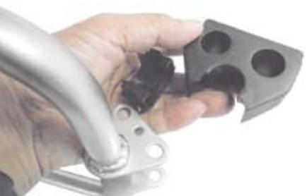
○ステップバーを止めている4本のフランジボルトを一旦緩め、微調整が可能な様にしておきます。
