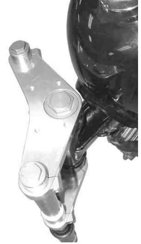
20. ステアリングシステムの割り締めボルトを緩め、インナーチューブの突き出し量が左右同じになるように調節します。
