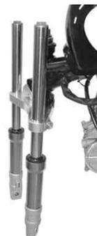
19. ワイヤハーネス等の取り回しがノーマルと同じになるようにしながらトップブリッジをフロントフォークとステムシャフトに通し、ステムワッシャを入れてステムナットを指定トルクで締め付けます。
