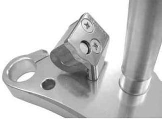
14. ステアリングシステムのボトムコーンレースをポンチドライバーやタガネ等を取り外し、ダストシール、ダストシールワッシャを取り外します。ジュラルミンシステムシャフトにダストシールワッシャ、ダストシール、ボトムコーンレースをそれぞれ取り付けます。
