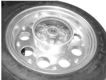
27. ブレーキシュー、フロントブレーキカムを弊社ブレーキパネルに付け替えます。弊社ブレーキアームをフランジボルト(6×25)でフロントブレーキカムに取り付けます。
