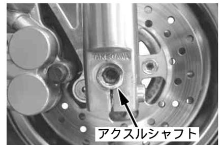
35. アクスルシャフトの側面にあるソケットキャップスクリューを締め付けます。
