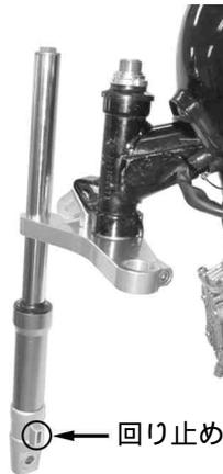
18. 左側を右側と同様に取り付けます。フロントフォーククランプタイプのヘッドライトステーを使用する場合は、ヘッドライトステーをフロントフォークに通して下さい。
