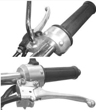
25. ホーンを取り付けます。(写真はステアリングシステムに取り付けた場合です。) ステアリングシステムに取り付ける場合、写真の様に折り曲げ、フランジボルト(6×15)で取り付け、締め付けます。
