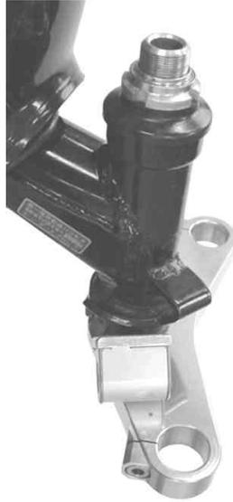
17. ステアリングシステムにフロントフォークのアクスルホルダーにブレーキの回り止めが付いている方を進行方向に向かって右側に通し、ステアリングシステム割り締めボルト（8×20）を仮り締めします。
