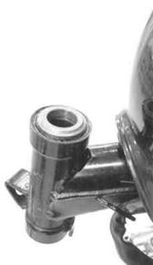
16. ステアリングシステムをヘッドパイプに通し、トップスレッドは手でいっぱい締め付けます。左右に4、5回躍動させベアリングをなじませ、約1/8回転戻し、ガタが無く軽く動くことを確認して下さい。
