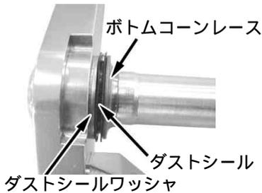
15. トップコーンレース及びボトムコーンレースにグリスを塗布し、ベアリングをステアリングシステム、ヘッドパイプに取り付け、トップコーンレースをヘッドパイプに取り付けます。ベアリングのボールが樹脂に組み込まれていないタイプの場合はボトムコーンレース、トップコーンレースにそれぞれ2個ずつ取り付けて下さい。ベアリングはグリスを塗る前に洗油で洗い、ゴミを付着させないで下さい。
