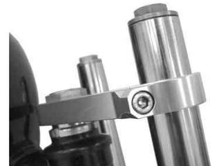
21. ステアリングシステムの割り締めボルトを指定トルクで締め付けます。
