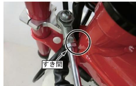
○最後にステアリングを左右にロック状態まで切り、ダンパーステーがメインハーネスに引っかかっていないか、ステアリングダンパーが動作する上で、どこも干渉がないかを確認して下さい。
