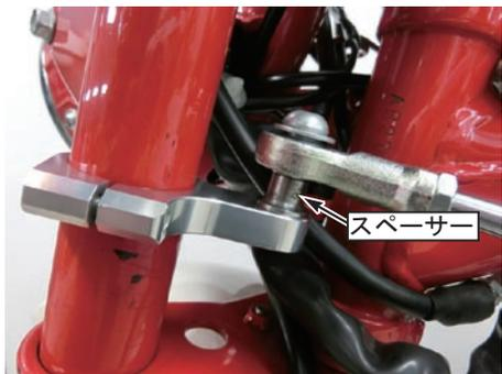
○フレームステーの角度を合わせます。ステアリングステムとダンパーが真横から見て 90 度になるように角度を調整します。もしスロットルケーブルのガイド部にフレームステーが干渉する場合は、フレームステーが干渉しないようにガイド部を調整して下さい。フレームステーの角度が決まりましたら、フレームステーのフランジナット 6mm を規定トルクで締め付けます。
