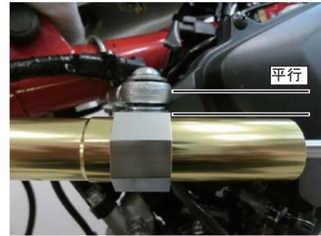
○ステアリングを左右にロック状態まで切り、ステアリングダンパーとフロントフォーク及びフレームが当たらないようにダンパーステーの角度を調整して下さい。ステアリングダンパーがステアリングストッパーにならないように注意して下さい。調整が出来たら、ソケットキャップスクリュー 5x25 を規定トルクで締め付けます。
