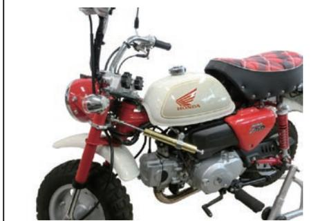
○ステアリングダンパーの減衰調整は、アジャスト部を右回転（時計回り）すると強くなり、左回転（反時計回り）にすると弱くなります。調整は最弱状態から徐々に行い、適度なダンピングに調整して下さい。必要以上には強めないで下さい。
