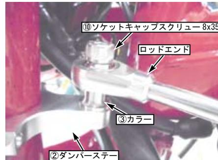
○ステアリングダンパーのロッドがフロントフォークに対して垂直になる様、②ダンパーステーの位置を指定寸法範囲に調整し、①フレームステーの位置を調整し、②ダンパーステー部の⑧ソケットキャップスクリュー 5x25 を規定トルクまで締め付けます。
