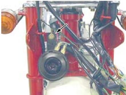
★ヘッドライトケースを左ライトステーの合わせマークに合わせて取り付け、ボルトを規定トルクで締め付けます。
