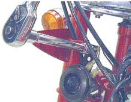
★ワイヤーハーネスをライトケースから引き抜きヘッドパイプ左側からライトケースに入っているハーネスを、ヘッドパイプ右側よりライトケースに入る様取り回しを変更します。
