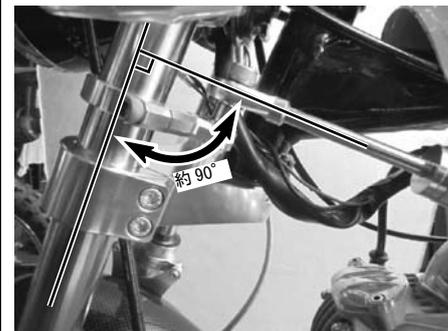
●オイルクーラー取り付け車両は、オイルクーラーのバンジョー部にステアリングダンパーのシェルボディーが干渉しない位置にホルダーのクランプ位置を微調整します。(オイルクーラー装着時は、若干 90° からズレますが、ロッドエンド角度の範囲内の為、特に問題ありません。)
