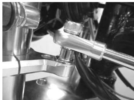
○ステアリングダンパーのロッドがフロントフォークに対して垂直になる様、②ダンパーステアの位置をステアリングステムから指定寸法範囲に調整し、①フレームステアの位置を微調整して、②ダンパーステア部のソケットキャップスクリュー 6x25 を規定トルクまで締め付けます。
