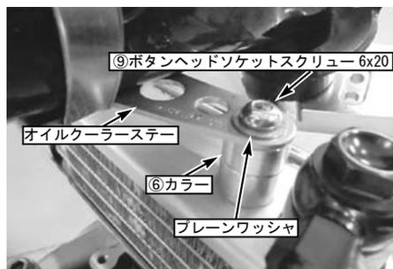
●オイルクーラーホースの取り回しを変更します。ステアリングダンパーを取り付ける部分にホースを取り回している場合、オイルクーラーステアとオイルクーラーとの間を通し取り回しを変更します。
