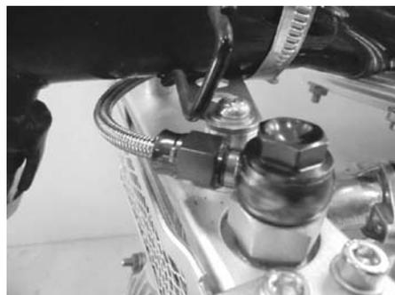
★オイルクーラーホースを AN#6 等のフィッティングをご使用の場合、フィッティング部がステアリングダンパーと干渉する為、同時装着出来ません。又オイルクーラー本体を、上下反対に取り付けてもフィッティング部がシリンダーヘッドに干渉する為、対応出来ません。ご了承下さい。
