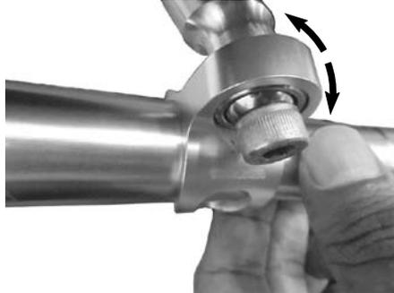
○①フレームステーの⑦フランジリナットを、規定トルクで締め付けます。
