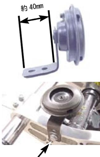
○上記ホーン取り付け方において、ノーマルフロントフェンダーをステアリングシステムに取り付ける場合、フロントフェンダーとステアリングシステムの間にはホーンを挟み、もう片側に付属のプレーンワッシャ 6mm を挟み、ノーマルのボルトにて取り付ける。
