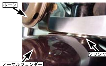
※上記のフェンダーの取り付け方はシリンダーヘッドの種類やボアアップの組み合わせ、部品の個体差によりフェンダーが干渉する可能性がある。位置の調整を行っても干渉する場合、フェンダーの干渉部分をカットして対応する。
