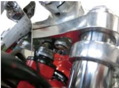
○ハンドルブラケットのUP マークを上向きにし、マスターシリンダー ASSY. を取り付ける。フランジボルトを上下の順に規定トルクで締め付ける。
