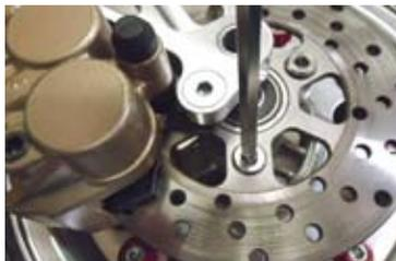
○キャリアブラケットの切り欠き部をフォークボトムケースの周り止めに合わせてホイール、スピードメーターギア、付属の7.5mmカラーを両フォーク間にセットして付属のフロントホイールアクスルを車両左側から差し込み、ノーマルアクスルナットを使用して仮止めする。
