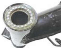
○トップスレッドを手でいっぱいまで締め付け、4、5回左右に摺動してステアリングボールを馴染ませる。トップスレッドを1/8回転戻してガタが無く軽く左右に動く事を確認する。
