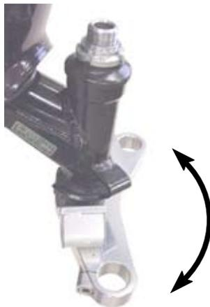
○付属のR. フロントフォーク（ボトムケースに回り止めあり）を車体の右側に、L. フロントフォークを車体の左側にステアリングシステムに差し込み、フロントフォークが抜け落ちてこないようにソケットキャップスクリュー（オフセット40mm:8x20、オフセット60mm:8x25）2本を仮止めしておく。
