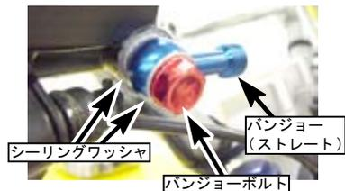
○ブレーキキャリパーにシーリングワッシャ、バンジョー（45°）、シーリングワッシャ、バンジョーボルトの順で取り付け、仮締めする。
