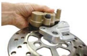
○フロントブレーキハブ COMP. に上記の状態のディスクローターをディスクボルト3本にて取り付ける。
