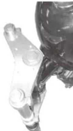
○フロントフォークの突き出し量をL. 及びR. が同じになるように調整します。ステアリングシステムのソケットキャップスクリューを規定トルクにて締め付け、トップブリッジのフォーク締め付け用のソケットキャップスクリュー6x20を取り付ける。
