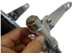
○付属のトップブリッジをステムシャフト及びフォークに通し、付属のステアリングシステムナットワッシャと付属のステアリングシステムナットを取り付ける。
