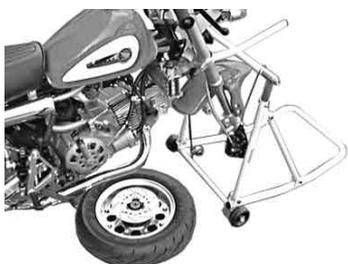
フロントホイールハブよりディスクプレートを取り外します。ホイールハブスペーサーをディスクボルト 8 × 20 でフロントホイールハブに取り付け、ボルトを指定トルクで締め付けます。
