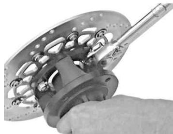
ホイールにハブを取り付けます。ホイールハブに、サイドカラーとメーターギヤボックスをセットし、フォークにアクスルシャフトを通し、アクスルナットを仮締めします。フロントフォークにキャリパーブラケットをフランジキャップスクリュー 8 × 16 で仮締めします。ディスクプレートをパッドで挟む様にキャリパーをセットし、フランジソケットキャップスクリュー 8 × 35 でキャリパーブラケットに仮締めします。
