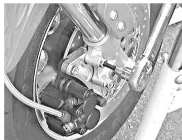
フロントスタンドを取り外します。スピードメーターギヤボックスの位置決めを行い、アクスルナットを指定トルクで締め付けます。
