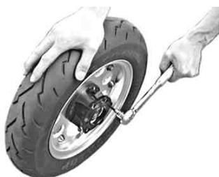
フローティングディスクプレートをディスクボルト 8 × 24 でハブスペーサーに取り付け、ボルトを指定トルクで締め付けます。
