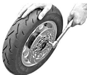
ホイールよりハブを取り外し、ディスクボルト 8 × 24 にロックナット 8 mm を取り付け、指定トルクで締め付けます。
