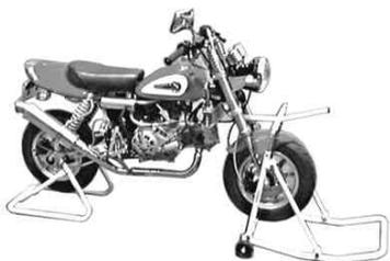
ホイール取り付けボルトを緩めキャリパーとキャリパーブラケットを取り外します。アクスルシャフトを抜き取りフロントホイールを取り外します。ブレーキホースに無理が掛からない様にキャリパーを保持して下さい。
