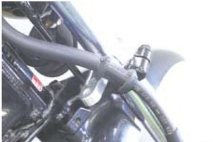
○キット内の①フレームステーを③Uボルト 6x15 で指定位置にフレームに取り付け、⑧フランジUナットを用いて仮締めします。
