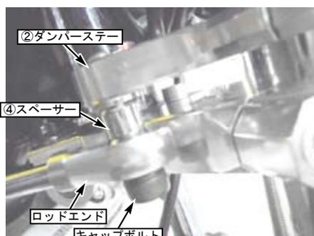
○ステアリングダンパーのロッドがフロントフォークに対して垂直になる様、②ダンパーステーの位置を指定寸法範囲に調整し、②ダンパーステー部の⑤ソケットキャップスクリュー 6x25 を規定トルクまで締め付けます。
