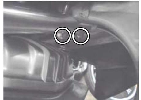
○ステアリングダンパーのホルダーを取り付けている⑤ソケットキャップスクリュー 8x25 を規定トルクまで締め付けます。
