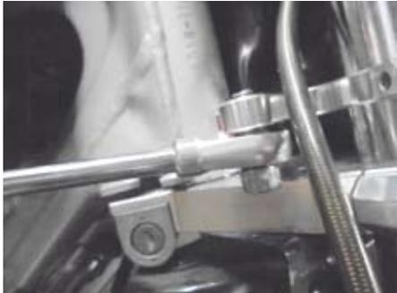
○ステアリングダンパーのロッドがフロントフォークに対して垂直になる様、①ダンパーステーの位置を指定寸法範囲に調整し、①ダンパーステー部の④ソケットキャップスクリュー 6x25 を規定トルクまで締め付けます。
