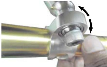
○②フレームステーの⑥フランジリナットを、規定トルクで締め付けます。
