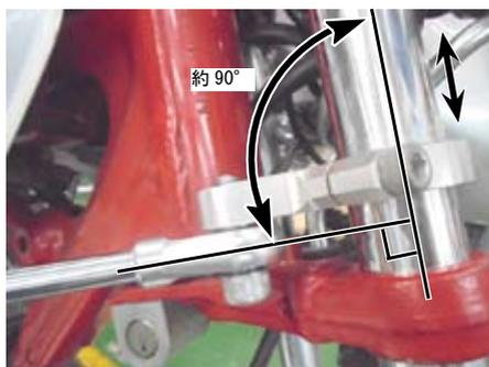
○ステアリングを左右一杯まで切った状態で、ステアリングダンパーと各部分にクリアランスがある事、ステアリングダンパーがステアリングのストッパーの代わりになっていない事、ステアリングダンパーのホルダーのボールエンド部（ピロボール）に遊びがあるかを確認します。
