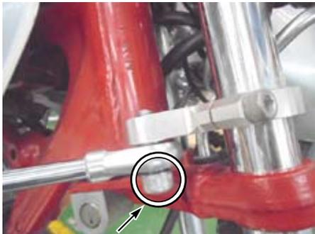
○ステアリングダンパーのロッドがフロントフォークに対して垂直になる様、①ダンパーステーの位置を指定寸法範囲に調整し、①ダンパーステー部のソケットキャップスクリュー 6x25 を規定トルクまで締め付けます。
