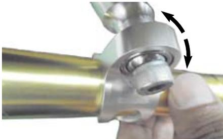
○②フレームステーの⑥フランジリナットを、規定トルクで締め付けます。
