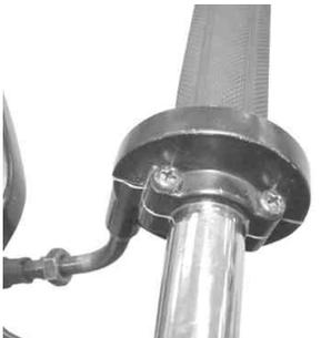
41. スロットルケーブルをノーマルと同様にキャブレターまで取り回し、キャブレターに取り付けます。
