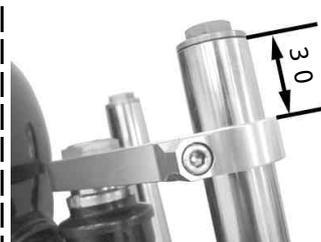
21. ステアリングシステムの割り締めボルトを指定トルクで締め付けます。
