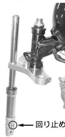
18. 左側も右側と同様に取付けます。ボスの出が多い方を外側にして、組み付けて下さい。
