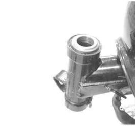
16. ステアリングシステムをヘッドパイプに通し、トップスレッドは手でいっぱい締め付けます。左右に4、5回躍動させベアリングをなじませ、約1/8回転戻し、ガタが無く軽く動くことを確認して下さい。
