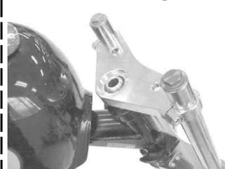
20. ステアリングシステムの割り締めボルトを緩め、インナーチューブの突き出し量が左右同じになるように調節します。
