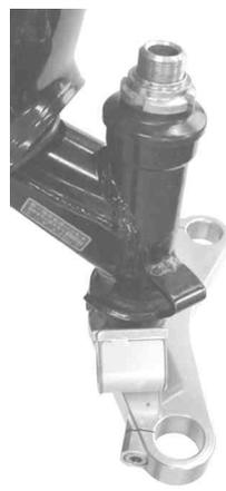
17. ステアリングシステムにフロントフォークのアクスルホルダーにブレーキの回り止めが付いている方を進行方向に向かって右側に通し、ステアリングシステム割り締めボルト(8×20)を仮り締めします。
