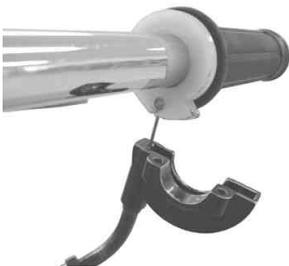
40. パンスクリューでアッパースロットルハウジングを口ワスロットルハウジングに取り付け、パンスクリューで締め付けます。
