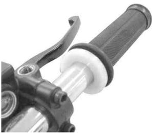
39. ハイスロットルセットの口ワスロットルハウジングにセットのスロットルケーブルを仮止めし、スロットルパイプに取り付けます。
