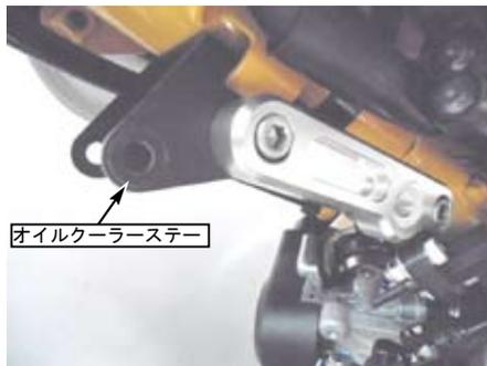
○左フロントフォークアウターチューブに①ダンパーステーを挟み④ソケットキャップスクリュー5x30で指定位置に仮締めをします。
