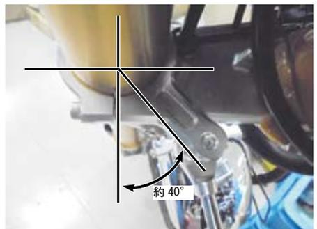
○ステアリングを左右一杯まで切った状態で、ステアリングダンパーと各部分にクリアランスがある事、ステアリングダンパーがステアリングのストッパーの代わりになっていない事、ステアリングダンパーのホルダーのボールエンド部（ピロボール）に遊びが有るかを確認します。
