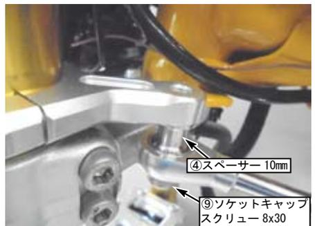
○ステアリングダンパーのロッドがフロントフォークに対して下記の位置になる様、①ダンパーステアを調整し、①ダンパーステア部の⑦ソケットキャップスクリュー 5x30 を規定トルクまで締め付けます。
