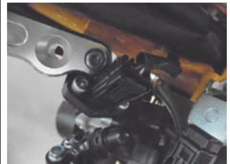
○ステアリングダンパーのホルダーに⑩ソケットキャップスクリュー8x80、③カラーを②ホルダーに取り付けます。
