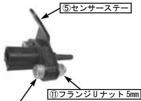
○ノーマルのエアクリーナーが取り付けられていた、フレームのステー部とキット内の②ホルダーの間に⑬ブレンワッシャ6.5x16x2.3、⑤センサーステーを挟み②ホルダーを⑧ソケットキャップスクリュー6x20を用いて取り付け、吸気温センサーとフューエルフィートホースが干渉しない様、⑤センサーステーの位置を調整し、規定トルクまで締め付けます。
