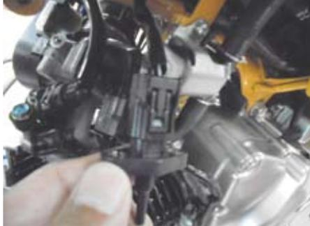
○⑤センサーステーに吸気温センサーを⑥ソケットキャップスクリュー5x15、⑪フランジUナット5mmを用いて取り付け締め付けます。
