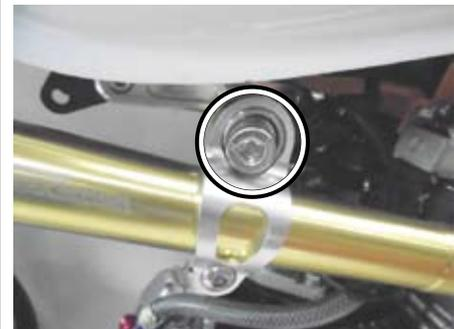
○ステアリングダンパーのホルダーのボタンヘッドスクリューを規定トルクまで仮締めします。
