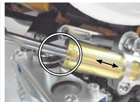
○各部の調整が終わったら、ステアリングダンパーのホルダーフレームステアの⑩ソケットキャップスクリュー 8x80 を規定トルクで締め付けます。
