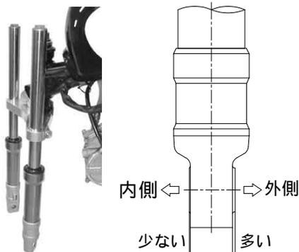
19. ワイヤハーネス等の取り回しがノーマルと同じになるようにしながらトップブリッジをフロントフォークとステムシャフトに通し、ステムワッシャを入れてステムナットを指定トルクで締め付けます。
