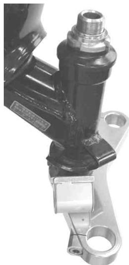
17. ステアリングシステムにフロントフォークのアクスルホルダーにブレーキの回り止めが付いている方を進行方向に向かって右側に通し、ステアリングシステム割り締めボルト(8×20)を仮り締めします。
