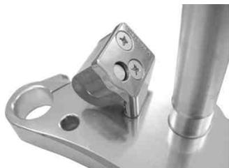
14. ステアリングシステムのボトムコーンレースをポンチドライバーやタガネ等で取り外し、ダストシール、ダストシールワッシャを取り外します。ジュラルミンシステムシャフトにダストシールワッシャ、ダストシール、ボトムコーンレースをそれぞれ取り付けます。
