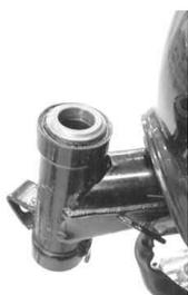
16. ステアリングシステムをヘッドパイプに通し、トップスレッドは手でいっぱい締め付けます。左右に4、5回躍動させベアリングをなじませ、約1/8回転戻し、ガタが無く軽く動くことを確認して下さい。
