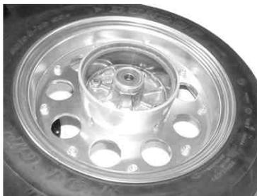
28. ブレーキシュー、フロントブレーキカムを弊社ブレーキパネルに付け替えます。弊社ブレーキアームをフランジボルト(6×25)でフロントブレーキカムに取り付けます。
