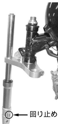
18. 左側を右側と同様に取り付けます。ボスの出が多い方を外側にして、組み付けて下さい。
