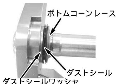
15. トップコーンレース及びボトムコーンレースにグリスを塗布し、ベアリングをステアリングシステム、ヘッドパイプに取り付け、トップコーンレースをヘッドパイプに取り付けます。
