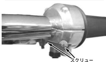
L ハンドルスイッチハウジングのアッパー、ロアを合わせてスクリーンを取り付けます。前側のスクリーンを先に締め付けてから後側のスクリーンを規定トルクで締め付けます。
