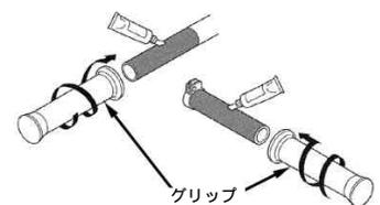
スロットルケーブル接続部、スロットルケーブル撻動部にグリスを塗布し、スロットルケーブルをスロットルパイプに接続します。
