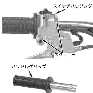
R ハンドルからハウジングのスクリーンを取り外し、スロットルを取り外します。
