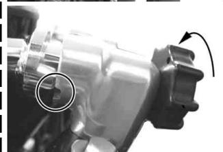
上記の状態でハンドルを折りたたんだまま、車両を輸送する場合、ハンドルは完全にロックされていない為、ハンドルバーにタイダウンベルト等を固定すると、ハンドルが緩み車両が倒れる可能性があります。車両を固定する場合、ハンドルバーは使用せず、他の部分を利用して下さい。
