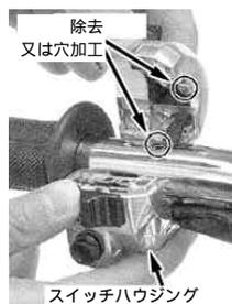
ケーブルの取り回しを調整します。ハンドルを折りたたんだ位置でもケーブル類がつかばらないかを確認します。
