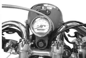
ハンドルホルダーのハンドルノブを再度確実に締め付けます。バックミラー、ワイヤーバンドを取り付けます。
