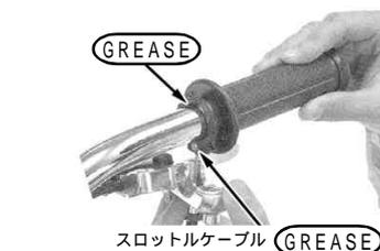
アッパー、ロアスロットルハウジングをセットし、スクリーンを取り付けます。前側のスクリーンを先に締め付けてから後側のスクリーンを規定トルクで締め付けます。
