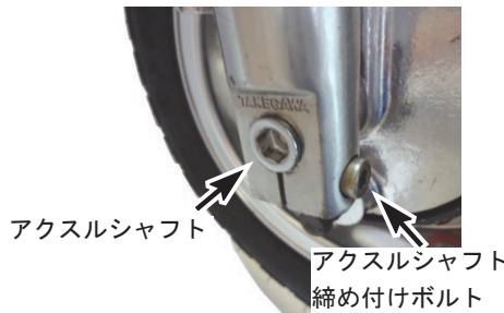
ソケットキャップスクリュー (オフセット40mm：8×20、 オフセット60mm：8×25)
