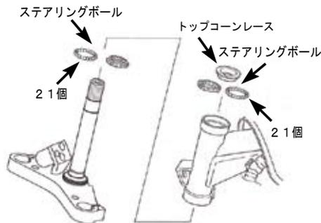
※スチールボールが分かれている車両の場合は、フレームのボールレースに十分な量のグリスを塗布した後、スチールボールを埋めて固定しながらステアリングシステムを差し込む等し、スチールボールが落下しないように工夫する。
