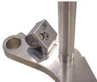
・各ステアリングボールと各コーンレースの摺動部にグリスを塗布する。ステアリングボールとトップコーンレースをフレームにセットし、ステアリングボールを取り付けたステアリングシステムをフレームに差し込む。
