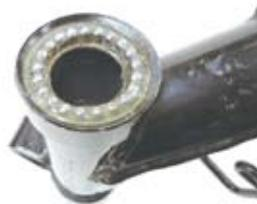
・トップスレッドを手でいっぱいまで締め付け、4、5回左右に撻動してステアリングボールを馴染ませる。トップスレッドを1/8回転戻してガタが無く軽く左右に動くことを確認する。
