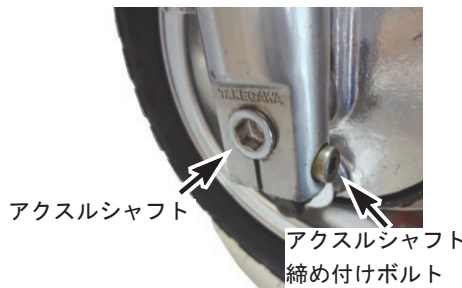
ソケットキャップスクリュー (オフセット40mm : 8×20、 オフセット60mm : 8×25)
