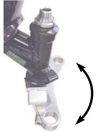
・付属のR. フロントフォーク (ボトムケースに回り止めあり) を車体の右側に、L. フロントフォークを車体の左側にステアリングシステムに差し込み、フロントフォークが抜け落ちてこないようにソケットキャップスクリュー (オフセット40mm：8x20、オフセット60mm：8x25) を仮止めしておく。
