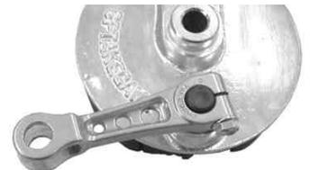
28. キット内のアクスルシャフトに薄くグリスを塗布してフロントホイールを外した時と逆の手順で取り付けます。
