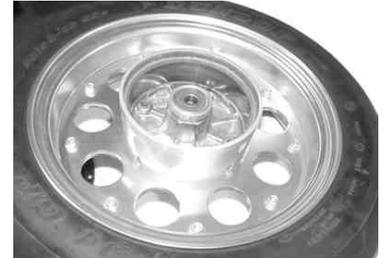
27. ブレーキシュー、フロントブレーキカムを弊社ブレーキパネルに付け替えます。弊社ブレーキアームをフランジボルト(6×25)でフロントブレーキカムに取り付けます。
