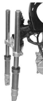
19. ワイヤハーネス等の取り回しがノーマルと同じになるようにしながらトップブリッジをフロントフォークとステムシャフトに通し、ステムワッシャを入れてステムナットを指定トルクで締め付けます。
