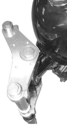
20. ステアリングシステムの割り締めボルトを緩め、インナーチューブの突き出し量が左右同じになるように調節します。
