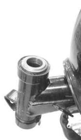
16. ステアリングシステムをヘッドパイプに通し、トップスレッドは手でいっぱいに締め付けます。左右に4、5回躍動させベアリングをなじませ、約1/8回転戻し、ガタが無く軽く動くことを確認して下さい。
