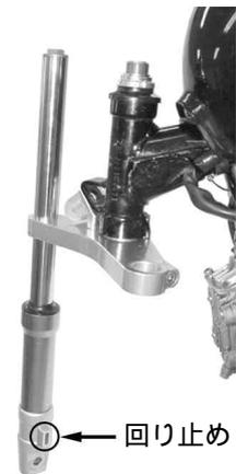
18. 左側を右側と同様に取り付けます。フロントフォーククランプタイプのヘッドライトステーを使用する場合は、ヘッドライトステーをフロントフォークに通して下さい。
