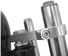
21. ステアリングシステムの割り締めボルトを指定トルクで締め付けます。
