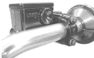
18. バンジョーボルトにシーリングワッシャ、バンジョー(ストレート)シーリングワッシャの順で通し、マスターシリンダーに取り付けて仮締めします。
