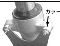
15. オプションのフロントフェンダーをフェンダーステーの間にセットします。ボタンヘッドスクリュー6×10を、フェンダーステーに差し込み、フェンダー裏側にブレンワッシャ、六角ナットで取り付けます。六角ナットをスパナで固定し、スクリューを指定トルクで締め付けます。
