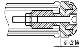
△注意: スロットル側のバーエンドを取り付ける際には、必ずラバーグリップとの間にクリアランスを設けた位置にバーエンドを取り付けて下さい。ラバーグリップと干渉している場合、スロットルの操作に支障を来します。
