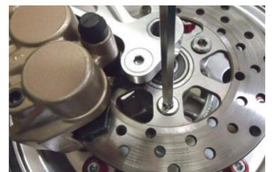
・キャリパーブラケットの切り欠き部をフォークボトムケースの回り止めに合わせてホイール、スピードメーターギア、付属の7.5mmカラーを両フォーク間にセットして付属のアクスルシャフトを車両右側から差し込み仮止めする。
