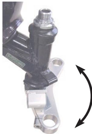
・付属のR. フロントフォーク（ボトムケースに回り止めあり）を車体の右側に、L. フロントフォークを車体の左側にステアリングシステムに差し込み、フロントフォークが抜け落ちてこないようにソケットキャップスクリュー（オフセット40mm:8x20、オフセット60mm:8x25）2本を仮止めしておく。
