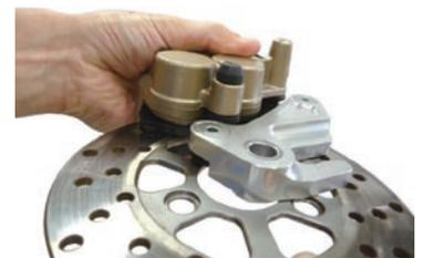
・フロントブレーキハブCOMP. に上記の状態のディスクローターをディスクボルト3本にて取り付ける。
