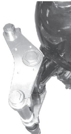
・フロントフォークの突き出し量を0mm～6.5mmの範囲内でL. 及びR. が同じになるように調整し、ステアリングシステムのソケットキャップスクリューを規定トルクにて締め付け、トップブリッジのフォーク締め付け用のソケットキャップスクリュー6x20を取り付ける。
