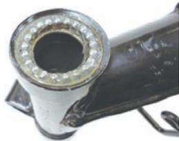
・トックスレッドを手でいっぱいまで締め付け、4、5回左右に摺動してステアリングボールを馴染ませる。トックスレッドを1/8回転戻してガタが無く軽く左右に動く事を確認する。
