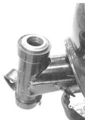
16. ステアリングシステムをヘッドパイプに通し、トップスレッドは手でいっぱいに締め付けます。左右に4、5回躍動させベアリングをなじませ、約1/8回転戻し、ガタが無く軽く動くことを確認して下さい。
