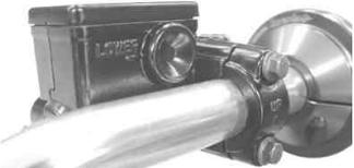
25. ホーンを取り付けます。(写真はステアリングシステムに取り付けた場合です。)ステアリングシステムに取り付ける場合、写真の様にステーを折り曲げ、フランジボルト(6×15)で取り付け、締め付けます。
