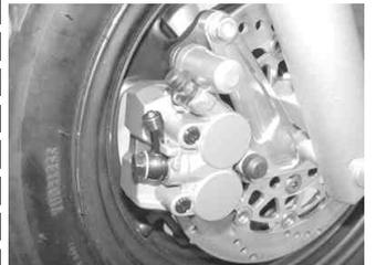
35. ブレーキホースを各バンジョーに取り付けます。バンジョーの取り付け角度、ブレーキホースの取り回しが決まれば、バンジョーボルト、ブレーキホースのフィッティングを指定トルクで締め付けます。
