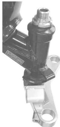
17. テアリングシステムにフロントフォークのアクスルホルダーにブレーキの回り止めが付いている方を進行方向に向かって右側に通し、ステアリングシステム割り締めボルト(8×20)を仮り締めします。
