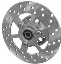
28. 10インチアルミホイールに、フロントホイールハブをフランジキャップスクリュー(8×20)で仮締めします。ノーマルオフセットホイール(0609033/054)を使用の場合フロントホイールハブとアルミホイールの間に付属のスペーサーを入れて下さい。エアバルブの向きは、乗車時方向で左にくるようにして下さい。
