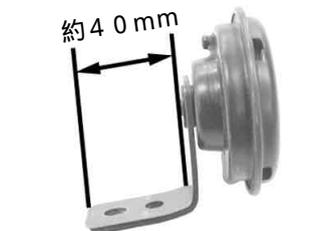
ノーマルフロントフェンダーを使用し、ホーンをステアリングシステムに取り付ける場合、フロントフェンダーとステアリングシステムの間にはホーンを挟み、もう片側はプレーンワッシャ(6mm)を挟むようにして取り付け、フランジボルト(6×15)で締め付けます。
