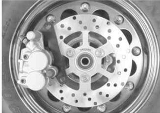
30. キャリパーをソケットキャップスクリュー(8×12)でキャリパーブラケットに取り付け、締め付けます。
