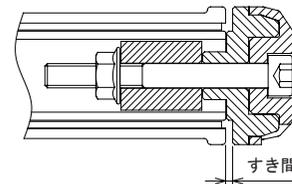
**!** 警告: スロットル側のバーエンドを取り付ける際には、必ずラバーグリップとの間にクリアランスを設けた位置にバーエンドを取り付けて下さい。ラバーグリップと干渉している場合、スロットルの操作に支障を来します。
