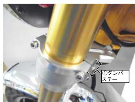
○別売りのステアリングダンパー本体に、図の様にホルダーを入れ指定位置に合わせます。ソケットヘッドスクリュー6x15、2本を規定トルクまで締め付けます。
