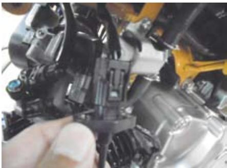
○ IAT センサーからOリングを外し、⑤センサーステーにIAT センサーを⑥ソケットキャップスクリュー5x15、⑪フランジUナット5mmを用いて取り付け締め付けます。
