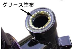
4. ジュラルミンシステムをステアリングヘッドに取り付けトップコーンレース、トップスレッドを取り付け、トップスレッドを手で一杯に締め付けます。
