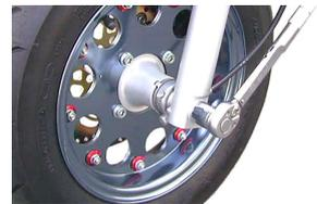
サイドカラーは、径の小さい方をハブ側に向けて取り付けして下さい。アクスルナット締め付け前にスピードメーターギヤボックスの位置調整を行って下さい。
