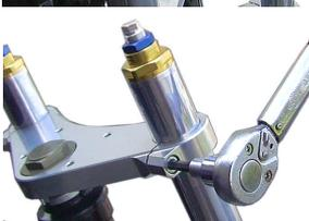
9. 10インチアルミホイールに、フロントホイールハブをアルミホイールに付属のフランジキャップスクリューで仮締めします。
