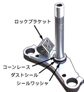
3. トップ及びボトムコーンレースにグリスを十分塗布し、スチールボールを取り付けます。
