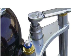
8. トップブリッジ割り締めボルトを指定トルクで締め付けます。
