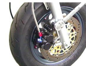
キャリパー取り付け時、キャリパーとホイールが干渉しますので、ホイールと干渉しなくなるまで取り付けボルトを緩めて下さい。ホイール取り付けボルトを指定トルクで締め付けます。
