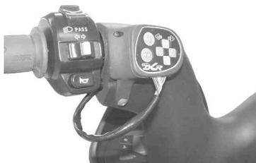
9. ミラーの8極カブラを コントロールボックスの8極カブラに接続し、ウインカーの配線を接続して、サイドパネルを取り付けて下さい。(左右同じ作業)
