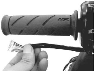
8. ハンドルアップカバー(リア側)をハンドルに取り付けます。この時、ハンドルアップカバーの左側に コントロールスイッチを被せ、STDスクリューにて固定します。
