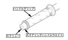
○L. ハンドルスイッチハウジングのスクリュー を外し、ハンドルからスイッチハウジングを 取り外します。
