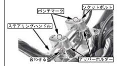
〇ポンチマークのある方(前方)のソケット ボルトを規定トルクで締め付けた後、反対側 のソケットボルト(後方)を規定トルクで 締め付けボルトキャップを取り付けます。
