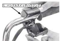
OR. ハンドルスイッチハウジングのスクリューを外し、スイッチハウジングを上下に分割し、スロットルパイプからスロットルケーブルの接続を外し、スイッチハウジングとスロットルパイプをハンドルから取り外します。
