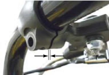
○ステアリングハンドルのスロットルパイプ部摺動部に薄くグリスを塗布し、取り外しと逆手順でスロットルパイプ、スロットルケーブルをR.ハウジングに取り付け、ハウジングの突起部とハンドルバーの穴位置を合わせ取り付け、2本のスクリューを締め付けます。
