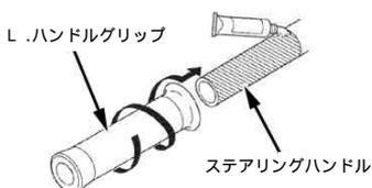
キットのステアリングハンドルのスロットルパイプ摺動部に薄くグリースを塗布しステアリングハンドルに取り外しと逆手順でスロットルパイプを取り付けスロットルケーブルを接続します。
