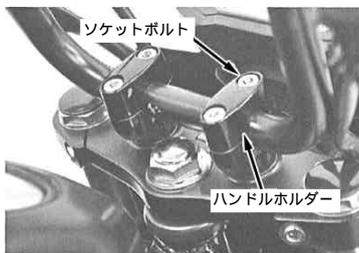
ステアリングハンドルの位置を調整し、ハンドルホルダーの前方のソケットボルトを規定トルクで締め付けた後、後方のソケットボルトを規定トルクで締め付けます。
