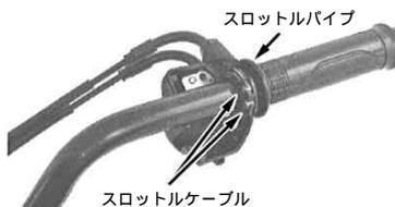
キットのステアリングハンドルのLグリップ部接着面にセメダイン#540を薄く塗布し、使用するグリップを回しながら取り付けます。
