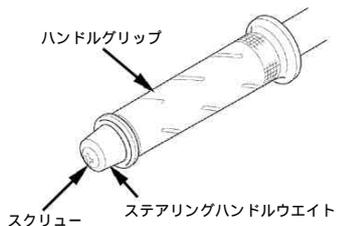
バックミラー/ワイヤーバンドを外し、Lハンドルバースイッチ及びクラッチレバーホルダーのスクリューを外し、ハンドルバーからスイッチ及びクラッチレバーホルダーを取り外します。
