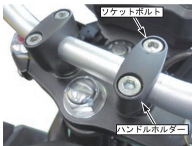
○ステアリングハンドルの位置を仮調整し、各ハンドルホルダーの前方のソケットボルトを仮締めした後、後方のソケットボルトを仮締めします。
