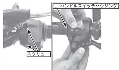
○純正ステアリングハンドルより、低いポジション設定としております。各ワイヤーハーネス、ブレーキホース、クラッチケーブル等、取り回しの変更が必要となります。仮調整し取り付けしたステアリングハンドル位置に、フロントブレーキレバーホルダー及びクラッチレバーホルダーを仮締めし、ケーブル類、ブレーキホース類の取り回しを調整します。GROM 2016 モデル及びMSX125SF (2016 モデル) はカウリングとブレーキホースとのクリアランスが確保出来る範囲でステアリングハンドル位置を調整して下さい。
