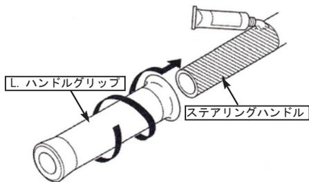
○キットのステアリングハンドルのスロットルパイプ摺動部に薄くグリースを塗布しステアリングハンドルに取り外しと逆手順でスロットルパイプを取り付けスロットルケーブルを接続します。
