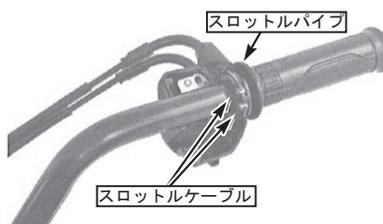
○キットのステアリングハンドルのL. グリップ部接着面にセメダイン #540 を薄く塗布し、使用するグリップを回しながら取り付けます。
