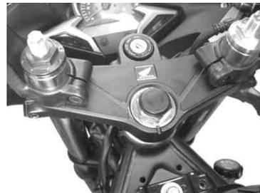
2. フランジナットが手で止まるまで仮締めし、ステアリングステムキャップを差し込みます。
