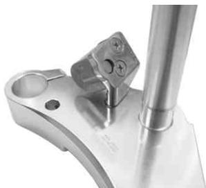
4. ステアリングステムのボトムコーンレースをポンチドライバーやタガネ等で取り外し、ダストシール、ダストシールワッシャを取り外します。ステアリングステムCOMP.にダストシールワッシャ、ダストシール、ボトムコーンレースをそれぞれ取り付けます。
