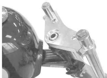
9. 27フロントフォークを取り付け、トップブリッジ、ステアリングステム割り締めボルトを規定トルクで締め付けます。
