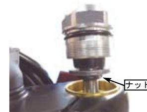
○フロントフォークに①フロントフォークトップボルトを0リング損傷に注意しながら手でいっぱいまで締め付けた後、規定トルクで締め付けます。
