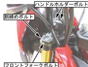
○フロントフォークボルトから0リングとラバーを外し、当キットの①フロントフォークトップボルトに取り付けます。
