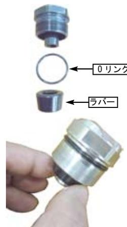
○フロントフォークインナーロッドに①フロントフォークトップボルトを取り付け、ナットを規定トルクで締め付けます。
