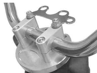
10. 取り付け要領4.7で取り外したL ハンドルスイッチ、スロットルグリップ、R ハンドルスイッチ、L ハンドルグリップ等を取り付けます。スロットルケーブルブレーキケーブル等はハンドルポスト前部を通して取り回して下さい。
