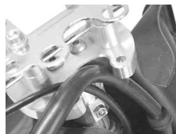
11. ヘッドライトステーをボタンヘッドスクリュー6×2.5、フランジUナット6mmを使用して取り付け、指定トルクで締め付けます。
