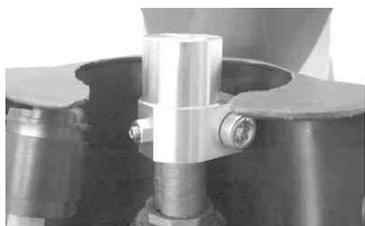
7. ハンドルポスト1を、ボタンヘッドスクリュー8×2.5を使用して取り付け、指定トルクで締め付けます。
