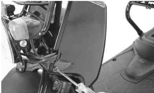
2. ウィンカー及びヘッドライトのコードを固定してあるフロントカバー付属のワイヤバンドを外し、ウィンカーコネクタとヘッドライトカブラの接続を外します。
