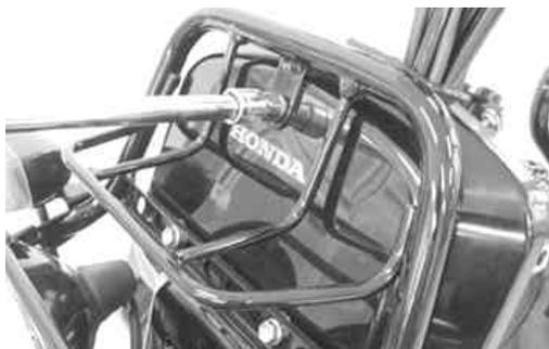
4. 純正スピードメーターの3Pカブラ、ギボシを外します。
