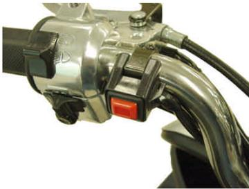
スタータースイッチコードのアース端子はフレームに取り付けます(写真)
