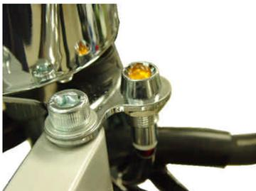
2. STDのスピードメーター内のインジケータASSY.を取り外し、灰色と桃色のコードにつながっているLEDを切断します。灰色と桃色のコードは短く切らないようにして下さい。インジケータASSY.のアース(写真)は折りたたんでおきます。
