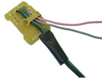
3. エレクトロタップを使用し、インジケータASSY.とインジケータコードを接続します(図参照)
