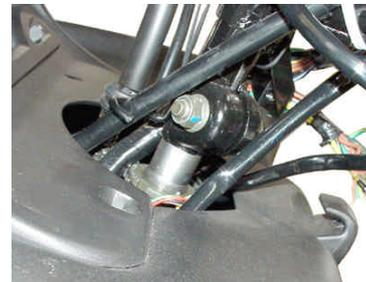
8. ハンドルブラケット A s s y . 裏側の 段付きボルトがきちんと締め付けられているか確認し、ソケットキャップスクリュー（M8×25）を緩め、ソケットキャップスクリュー（M8×30）を完全に取り外して下さい。
