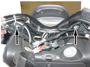
3. ワイヤー及びケーブル類をハンドルに固定してあるタイラップをニッパー等で切断し、ハンドルスイッチの配線カブラー類を取り外して下さい。
