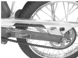
4. 車両がスーパーカブ・リトルカブでリアショックが弊社製リアショックアブソーバー：06 04 0112、06 04 0113、06 04 0114、06 04 0060をご使用の場合、図を参考にチェーンガードとリアショックアブソーバーの間にキット内のブレンワッシャ 10mmを入れ、取り付けます。
