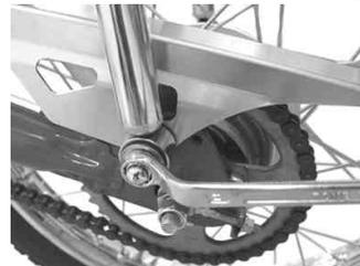
6. フランジボタンヘッドスクリューを規定トルクまで締め付けます。
