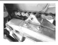
4.キット内のフランジボタンヘッドスクリューを用いてチェーンガード をスイングアームに取り付けます。
