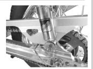
. フランジボタンヘッドスクリューを規定トルクまで締め付けます。
