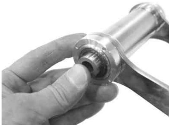
キットのクッションリンクを車体にセットし、ノーマルのリンクボルト/ナットを仮止めします。
