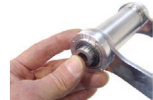
◇①クッションロッド COMP. を車体にセットし、リア側に②フランジボルト 10x90、ノーマルのナットを仮止めします。
